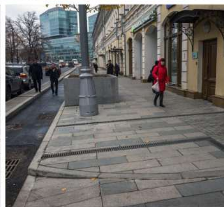
Пример решения проезда в одном уровне покрытий улица Пушечная, Москва
